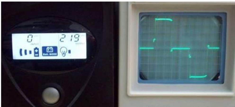
*Para realizar este ensayo se alimentó un sistema ininterrumpido de 24v 3Amp compuesto por un transformador de 220/24v 200VA (1A) y su placa electronica, dicho sistema funciona en el rango de 170 a 235Vca.*
