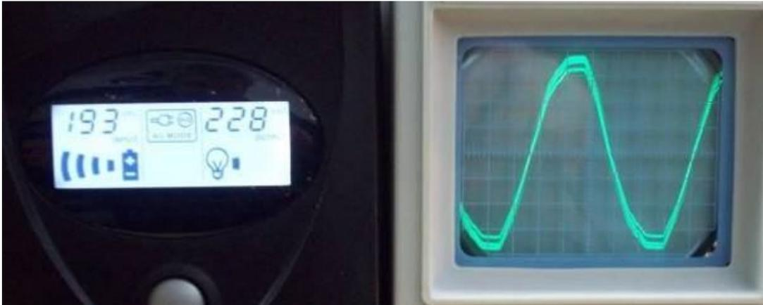
Al ampliar la imagen se visualiza el recorte de onda y la superposición de las mismas:
