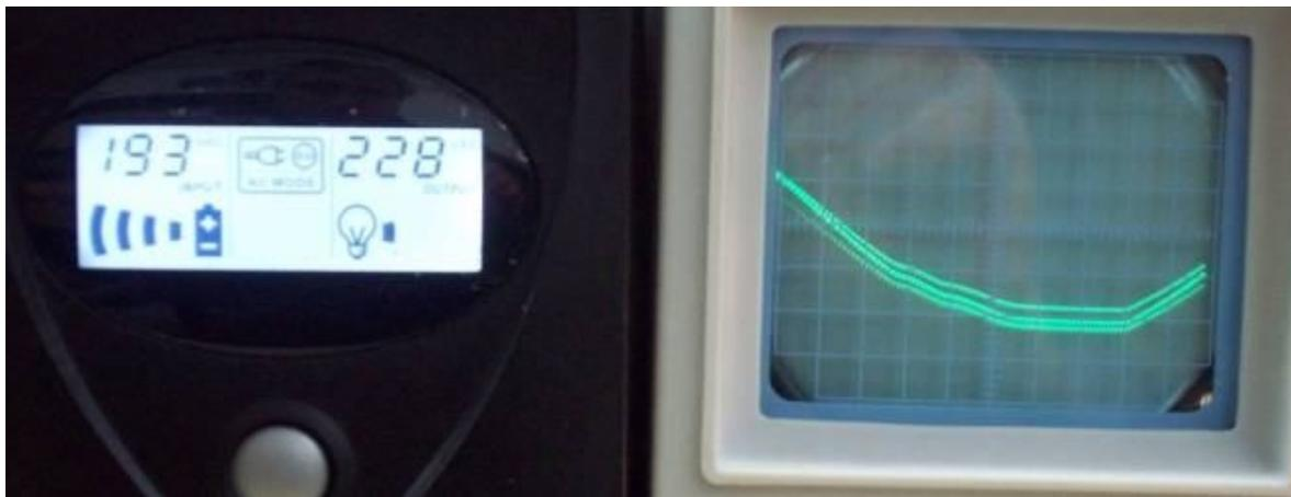
Ídem al caso anterior los equipos funcionan con mínimas posibilidades de falla, incluso los transformadores de carga y otros consumos tienden a linealizar la onda de salida que sigue siendo sinusoidal.
