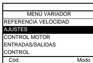
Paso al menú **[MENÚ VARIADOR]** automáticamente después de 3 segundos. Elija el menú y pulse ENT.
