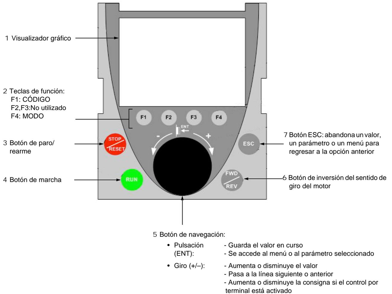
**Nota:** Las teclas 3, 4, 5 y 6 permiten controlar directamente el variador, si el control por terminal está activado.
