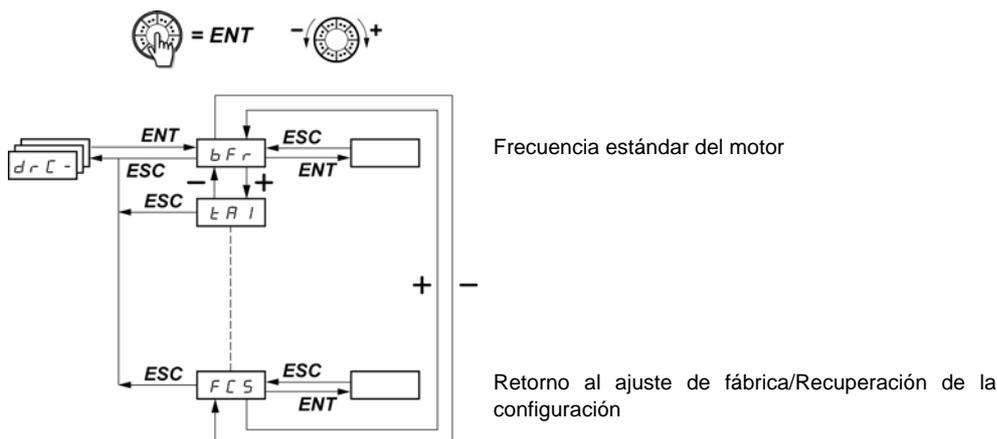
Los parámetros sólo se pueden modificar en parado (sin orden de marcha), excepto [Autoajuste] (tUn), que puede provocar la puesta en tensión del motor.
