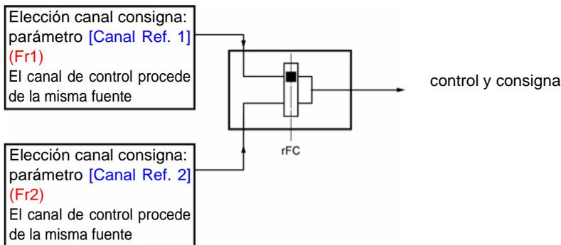
El parámetro [Conmutación Ref.2] (rFC) permite elegir el canal [Canal Ref. 1] (Fr1) o [Canal Ref. 2] (Fr2) o configurar una entrada lógica o un bit de control para conmutar a distancia el uno o el otro.
