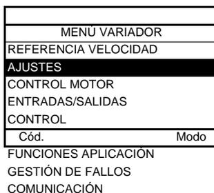
Paso al menú [\[MENÚ VARIADOR\]](#) automáticamente después de 3 segundos. Elija el menú y pulse ENT.
