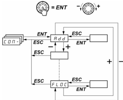
Los parámetros sólo pueden modificarse en parada, sin orden de marcha. Las modificaciones de los parámetros [Direc.Modbus] (Add), [Velocidad Modbus] (tbr), [Formato Modbus] (tFO), [Dirección CANopen] (AdCO) y [Velocidad CANopen] (bdCO) sólo se tienen en cuenta después de apagar y encender el equipo.
