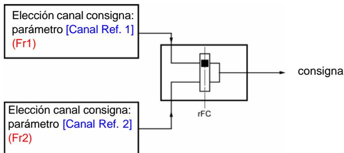
El parámetro [Conmutación Ref.2] (rFC) permite elegir el canal [Canal Ref. 1] (Fr1) o [Canal Ref. 2] (Fr2) o configurar una entrada lógica o un bit de control para conmutar a distancia el uno o el otro.
