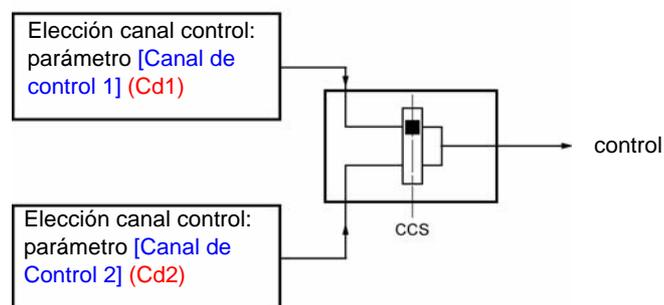
El parámetro [Conmut. canal Ctrl] (CCS) página 58 permite elegir el canal [Canal de Control 1] (Cd1) o [Canal de Control 2] (Cd2) o configurar una entrada lógica o un bit de una palabra de control para conmutar a distancia el uno o el otro.
